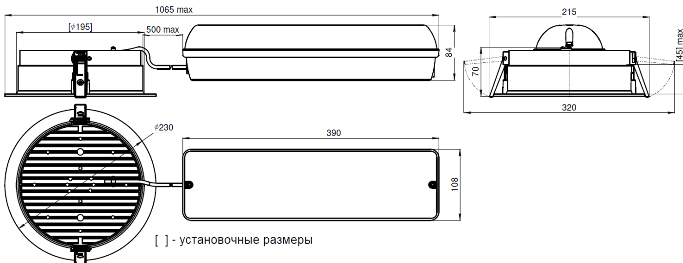
Рис. №2 Габаритный чертёж.
