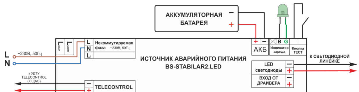
Рис. 2 Схема подключения BS-STABILAR2-83-B1-LED для аварийного светового прибора в непостоянном режиме:
