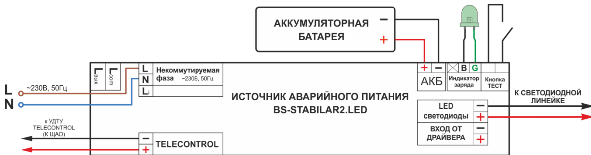
Рис. 2 Схема подключения BS-STABILAR2-81-B4-LED и BS-STABILAR2-83-B4-LED для аварийного светового прибора в непостоянном режиме:
