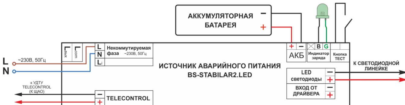
Рис. 2 Схема подключения BS-STABILAR2-81-B1-LED для аварийного светового прибора в непостоянном режиме:
